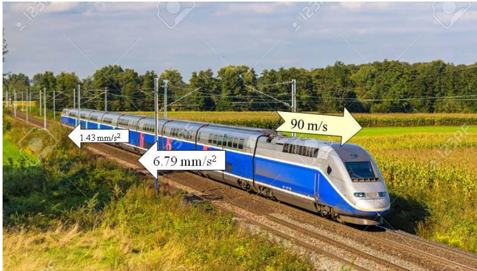
Figure 18 : Un TGV qui roule sur un rail droit de Rennes à Paris à une latitude de 47-48°. À une vitesse de u_r = 90 \text{ m/s} et à une distance de 4 262 kilomètres de l'axe de rotation de la Terre, il est touché par deux accélérations vers le sud, qui ensemble font 8,2 \text{ mm/s}^2 . L'une est due à l'effet de Coriolis ( 6,79 \text{ mm/s}^2 ) et l'autre est due à la courbure de la latitude ( 1,43 \text{ mm/s}^2 ). Cette dernière accélération, qui est toujours dirigée vers l'équateur 6 , existerait également si la Terre ne tournait pas. Si le train roulait dans le sens inverse, d'est en ouest, la force de Coriolis 2\Omega \sin(\text{latitude})u_r par unité de masse serait dirigée dans le sens inverse, vers le nord, l'autre restant dirigée vers le sud : l'accélération totale, désormais dirigée vers le nord, serait 5,36 \text{ mm/s}^2 .
