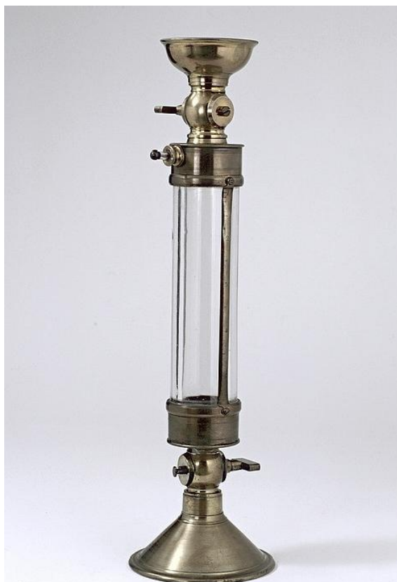
Figure 3 : Eudiomètre à eau utilisé par Gay-Lussac (cliché Bibliothèque de l'École polytechnique). L'eudiomètre est un instrument permettant de déterminer la proportion d'oxygène contenue dans l'air atmosphérique en le faisant réagir avec un excès d'hydrogène pour former de l'eau. L'appareil fonctionne posé sur une cuve remplie d'eau. L'air atmosphérique (ou le gaz analysé) est mélangé avec un excès d'hydrogène, et après combustion déclenchée par une étincelle, le volume d'oxygène contenu dans l'air est donné par le tiers de la diminution de volume du mélange gazeux accompagnant la réaction.
