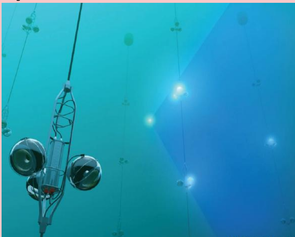
Figure 12 : Observatoire ANTARES en rade de Toulon. Un étage (unité de base) d'une ligne de détection avec ses trois modules optiques et l'électronique associée. Les sphères de verre renferment chacune un photomultiplicateur qui détecte la lumière Cerenkov émise par les particules. Sur la figure on remarque le cône bleuté lié au passage de l'une d'entre elles.
