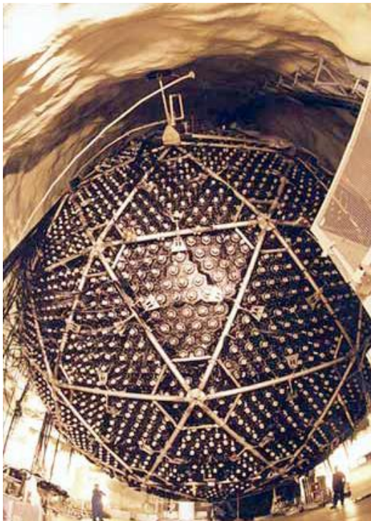
Figure 8 : Le détecteur Sudbury, sphère de 12m de diamètre. Grâce au réservoir d'eau lourde, les 9600 détecteurs de l'Observatoire de Sudbury, au Canada, détectent les trois saveurs de neutrinos. À droite, vue d'artiste de l'environnement physique : le détecteur est protégé des rayons cosmiques par la roche environnante (@SNO Observatoire de Sudbury).
