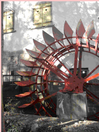
Figure 3 : La roue à aubes courbes ("à la Poncelet") du moulin de Lutterbach (Alsace), à gauche ; une roue à aubes planes, extrait de l'Introduction à la mécanique industrielle de Poncelet, à droite.
