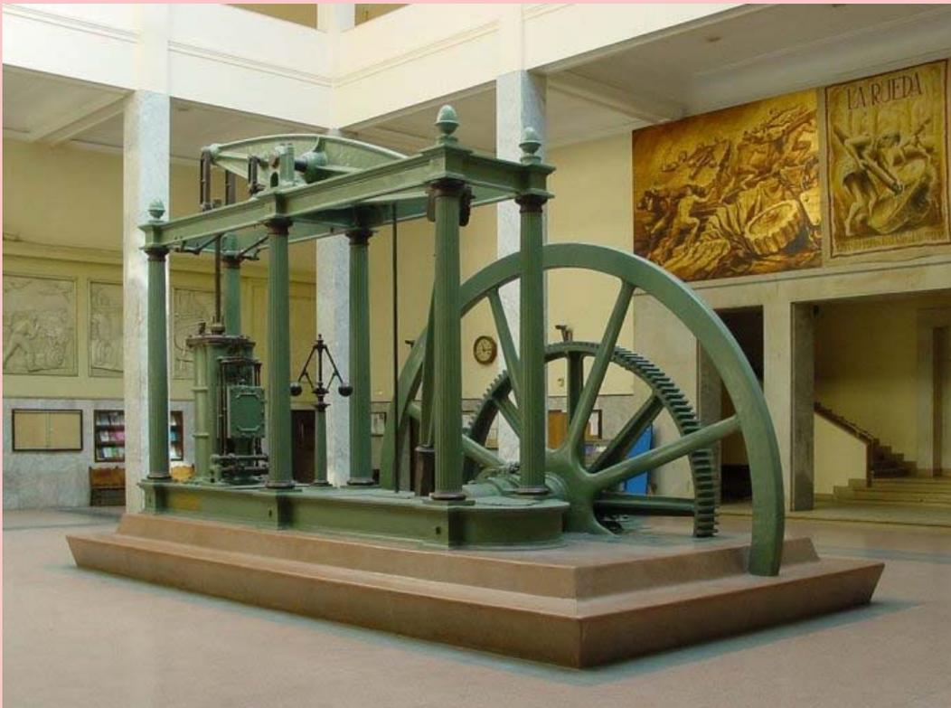
**Figure 2 :** *La machine à vapeur de Watt (1769). On remarque le régulateur centrifuge (boules coulissant sur un axe vertical) qui permet d'assurer un fonctionnement régulier de la machine, indépendant des variations de la puissance sollicitée en sortie (Image Wikipedia, Hall d'entrée de l'École technique supérieure d'ingénierie industrielle à Madrid – Université polytechnique de Madrid)*
