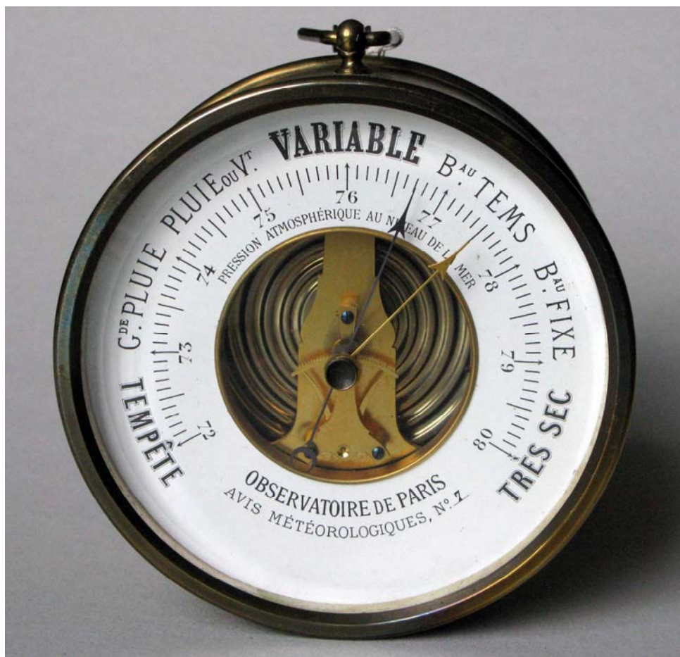
Figure 5 : Baromètre anéroïde (reproduction d'un objet des années 1860, Collections Observatoire de Paris). Le baromètre anéroïde (inventé par Lucien Vidi en 1844) utilise un autre procédé que le mercure – il fonctionne avec une chambre à vide (anéroïde = sans air) mesurant les variations de pression externe. Il indique néanmoins la pression avec les hauteurs de mercure : à droite les pressions supérieures à 76 cm (beau temps), à gauche les pressions inférieures (mauvais temps).
