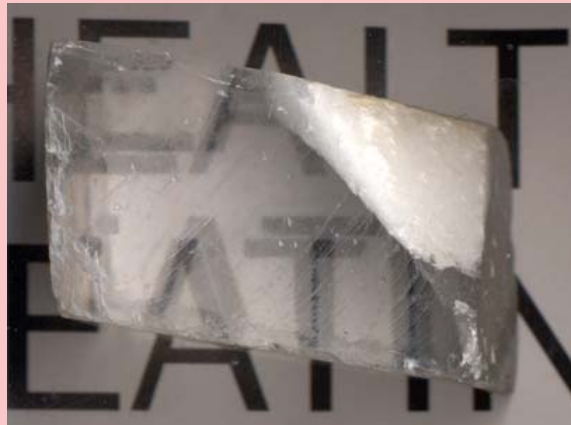
Figure 1 : Double réfraction à travers un cristal de spath d'Islande (calcite \text{CaCO}_3 ). L'image des lettres à travers le cristal, déjà décalée par rapport à l'image ne traversant pas le cristal (effet de réfraction), est par surcroît dédoublée (effet de double réfraction).
