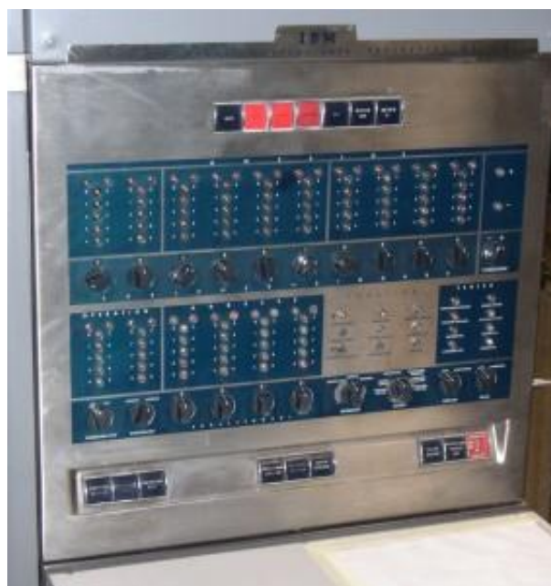
Figure 2 : En 1954, IBM France s'était adressée à J. Perret en vue de la livraison en France de sa première machine commerciale, l'IBM 650. En haut : Un IBM 650 à l'université du Texas A&M" (image Cushing Memorial Library and Archives, Texas A&M) ; à droite de la photo, le lecteur de cartes perforées IBM 533. En bas : détail de la console avant de l'IBM 650 (photo WikiCommons, auteur Maksim).
